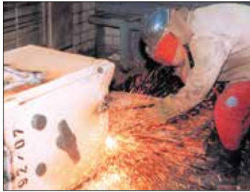
Abb. Prüfmethode mit Schneidbrenner Prüfmethode mit Diamantkronenbohrer
