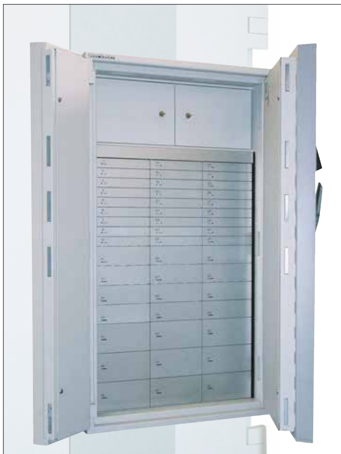
Abb. Mietfachtresor DWS1902S, zweiflügelig E-Schloss Kaba Paxos advance Set 1 (Tastatur) + Set 5, 2 versperrbare Innentresore, 48 Mietfächer
